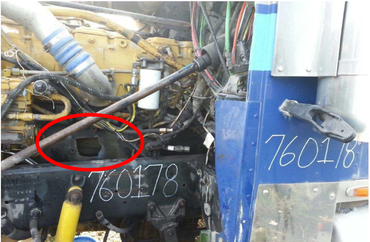
Figura 5. Foto de después, bloque del motor con agujero de 3 pulgadas o más
