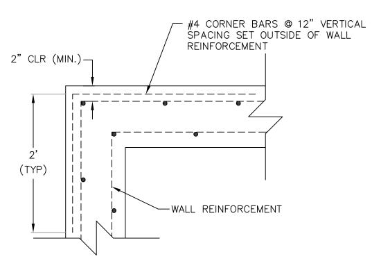
TYPICAL WALL CORNER DETAIL N.T.S.
