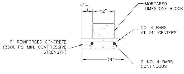
TYPICAL SMALL LIMESTONE BLOCK MSE WALL LEVELING PAD DETAIL
