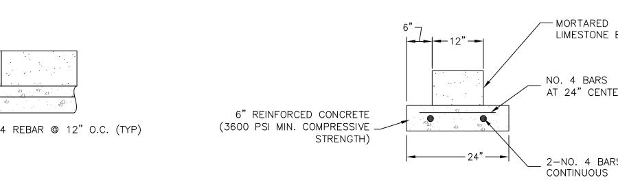
TYPICAL SMALL LIMESTONE BLOCK MSE WALL LEVELING PAD STEP DETAIL N.T.S.
