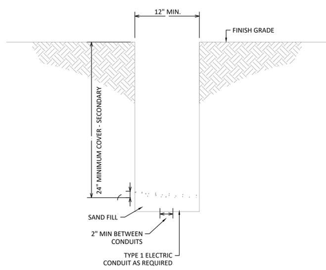
**3 ELECTRIC CONDUIT TRENCH DETAIL**
