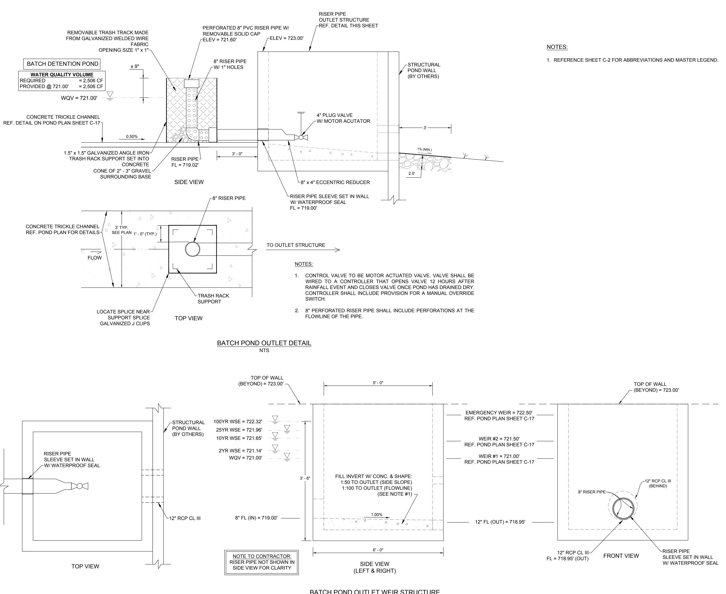
BATCH POND OUTLET WEIR STRUCTURE
