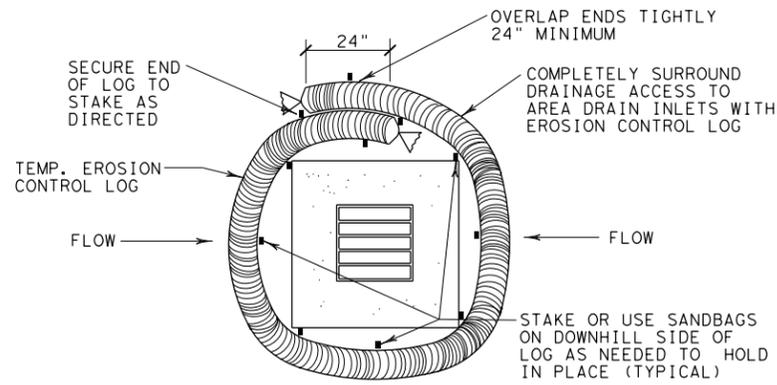
EROSION CONTROL LOG AT DROP INLET
