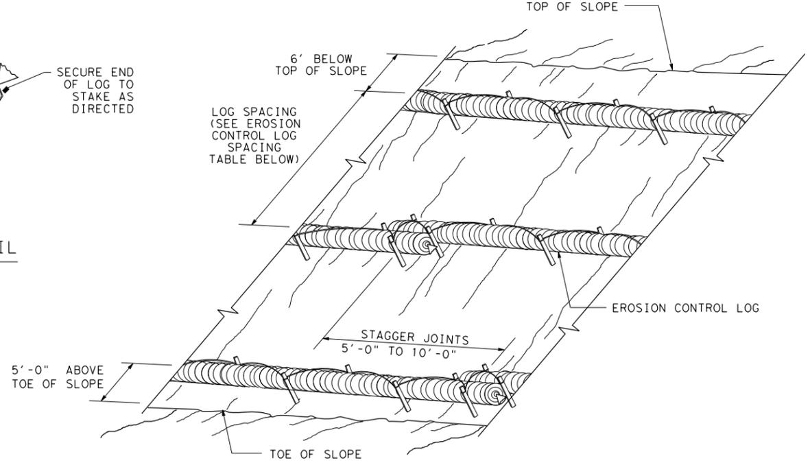
EROSION CONTROL LOGS ON SLOPES
