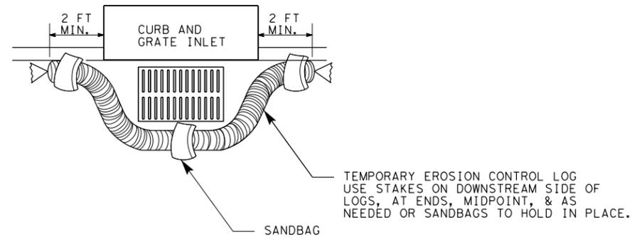
EROSION CONTROL LOG AT CURB & GRADE INLET
