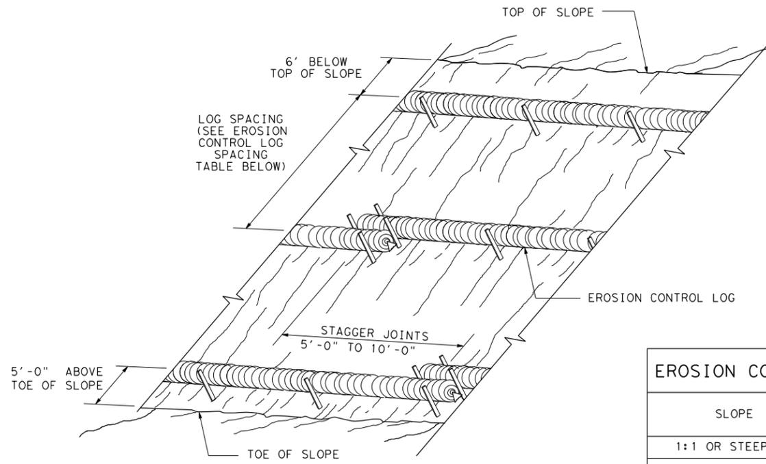
EROSION CONTROL LOGS ON SLOPES
