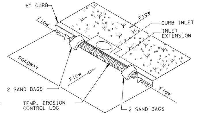
EROSION CONTROL LOG AT CURB INLET
