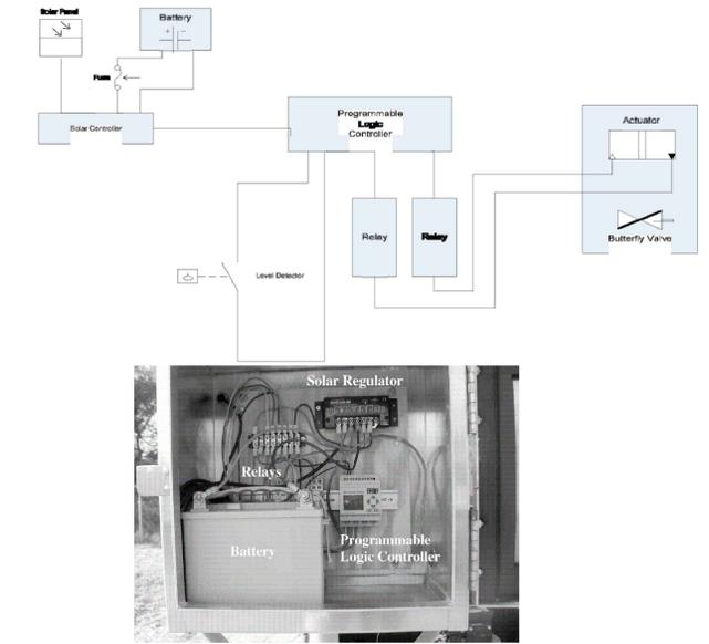
**1 LOGIC CONTROLLER BOX DETAIL**
