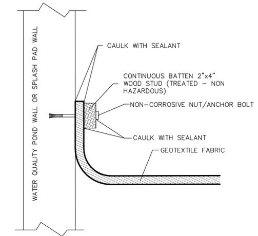
**4 GEOTEXTILE FABRIC CONNECTION DETAIL**
