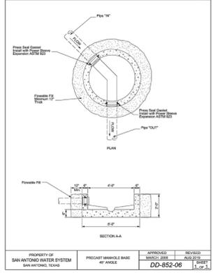
**PRECAST MANHOLE BASE OF ANGLE**
