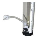
Figure 3.4. Secchi tube.
