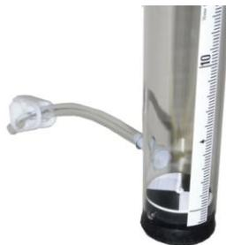
**Figure 3.4.** Secchi tube.
